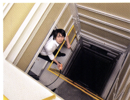
微小重力環境の実験は、津江研究室の小型落下塔で実施される。塔は約10メートルの高さで、微小重力環境を最大1.4秒再現できる。写真は塔の内部で作業をする梅村さん
