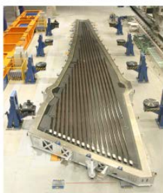
金属製と同じ構造様式 (外板・桁・リブ)
