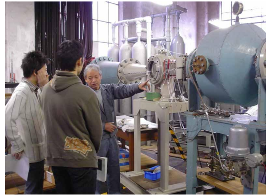
2003年に設置された小型超音速風洞の説明
